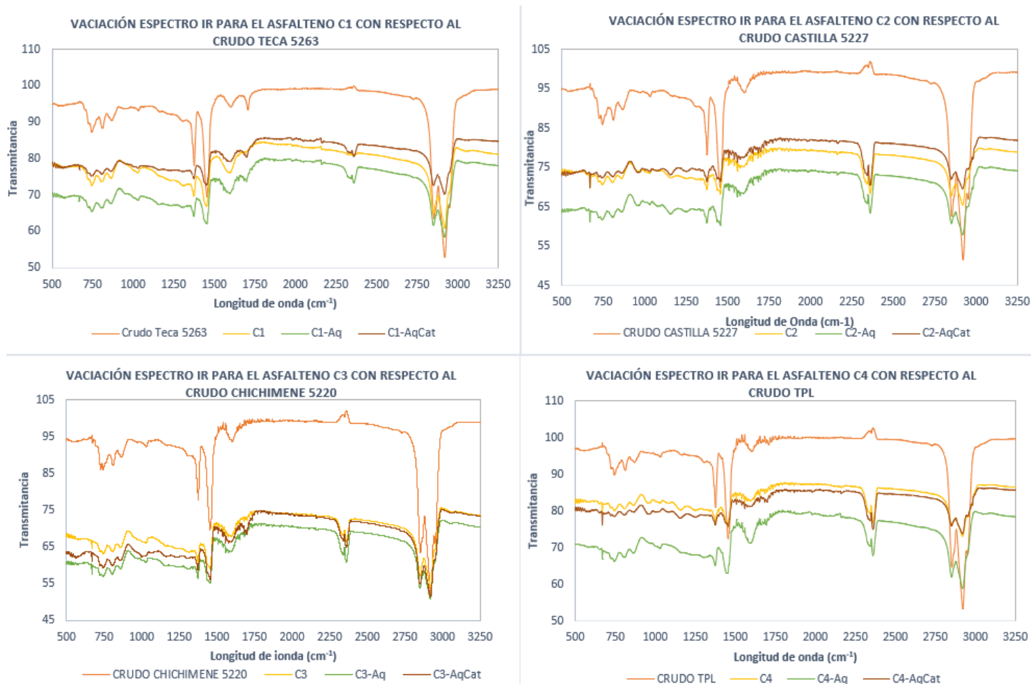
Figura 19: Espectros FTIR de los asfaltenos C1-C4, antes y después del proceso de acuatermólisis (con y sin catalizador).
