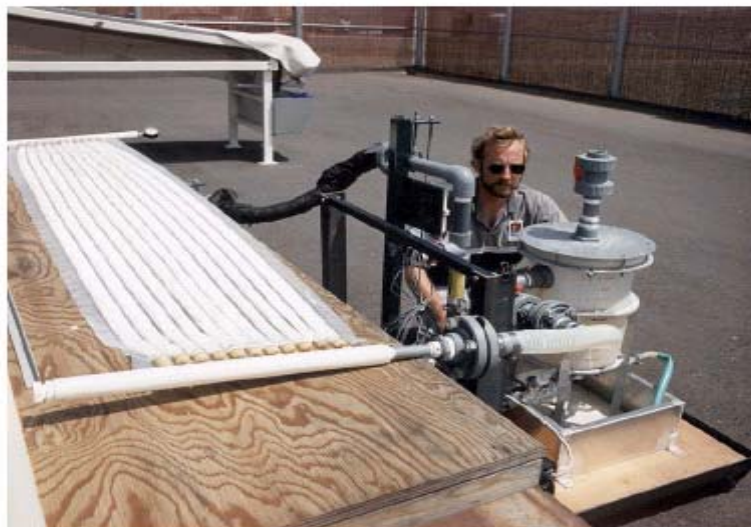
Figura 2.12 Colector tubular experimental desarrollado por NREL (National Renewable Energy Laboratory, Denver, USA). Foto por cortesía de NREL (USA)[10].
