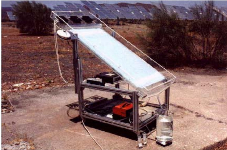
Figura 2.10. Instalación experimental de un colector de placa plana utilizado por el ISFH (Institut für Solarenergieforschung GmbH, Hannover, Alemania) en las instalaciones de la PSA[10].
