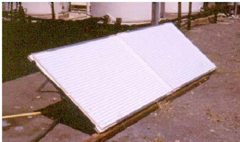
Figura 2.11 Instalación experimental de un colector de placa plana hueca construido a partir de materiales plásticos [10].
