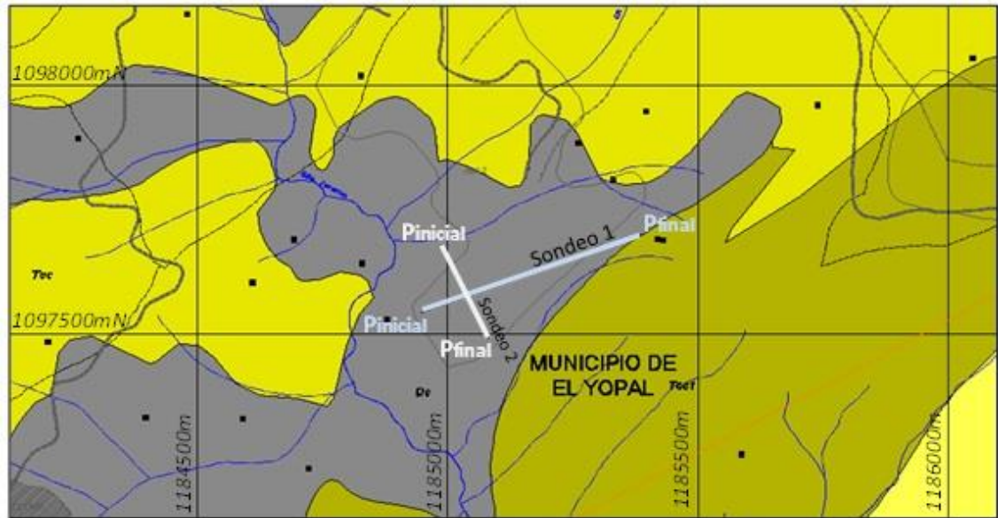
Figura 40. Localización de los perfiles de tomografía eléctrica realizados en el sector Floreña NW 6.
