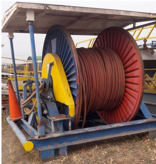
Figura 11. Cable de acero o guaya
