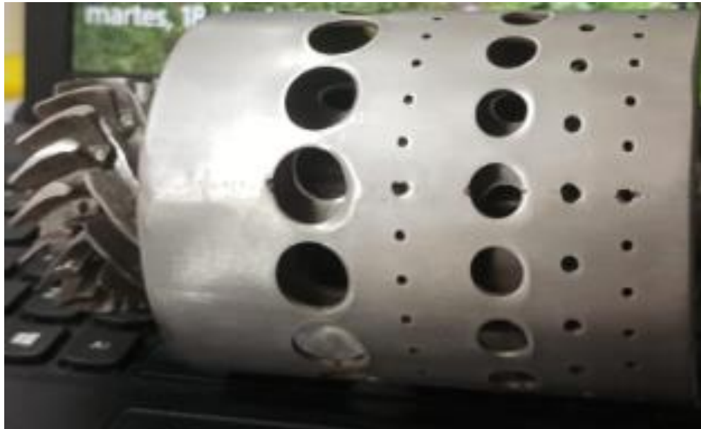
Figura 35. Rotor de turbina, estator y cámara de combustión.
