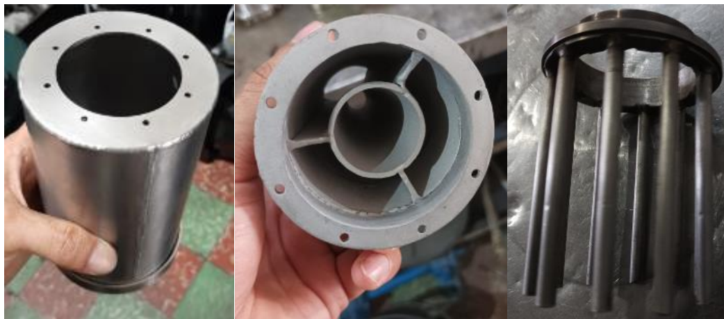
Figura 36. Carcasa, toberas de escape, tubos protectores.
