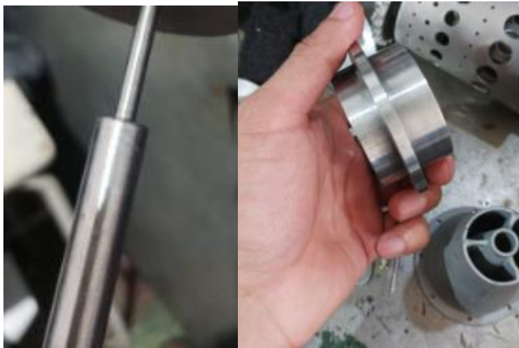
Figura 37. Eje, soporte de toberas
