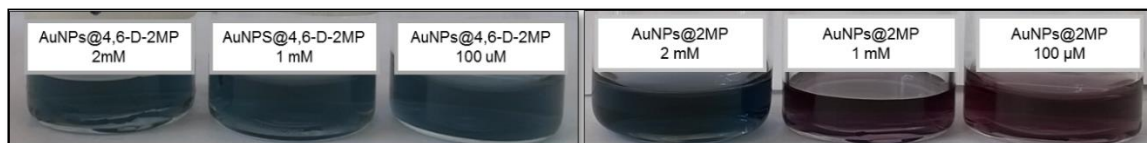
Figura 17. Fotografías del cambio de coloración para las AuNPs funcionalizadas con 2 MP y 4,6-D-2MP
