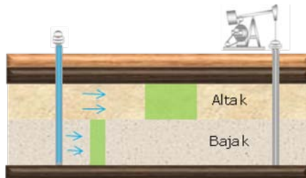
(b) Inyección de agua antes de la gelación.
