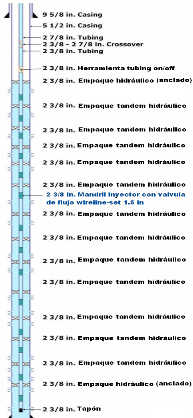
Figura 22. Completamiento con empaques hidráulicos.
