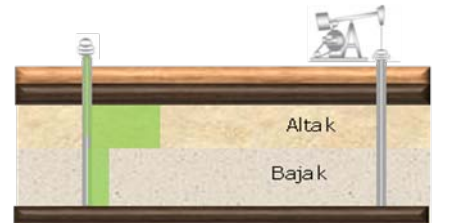
(a) Inyección de la solución gelante al yacimiento
