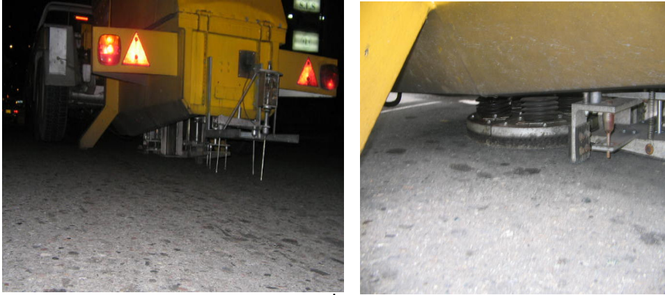
Figura 4. Sensores y plato de carga del equipo KUAB 50
