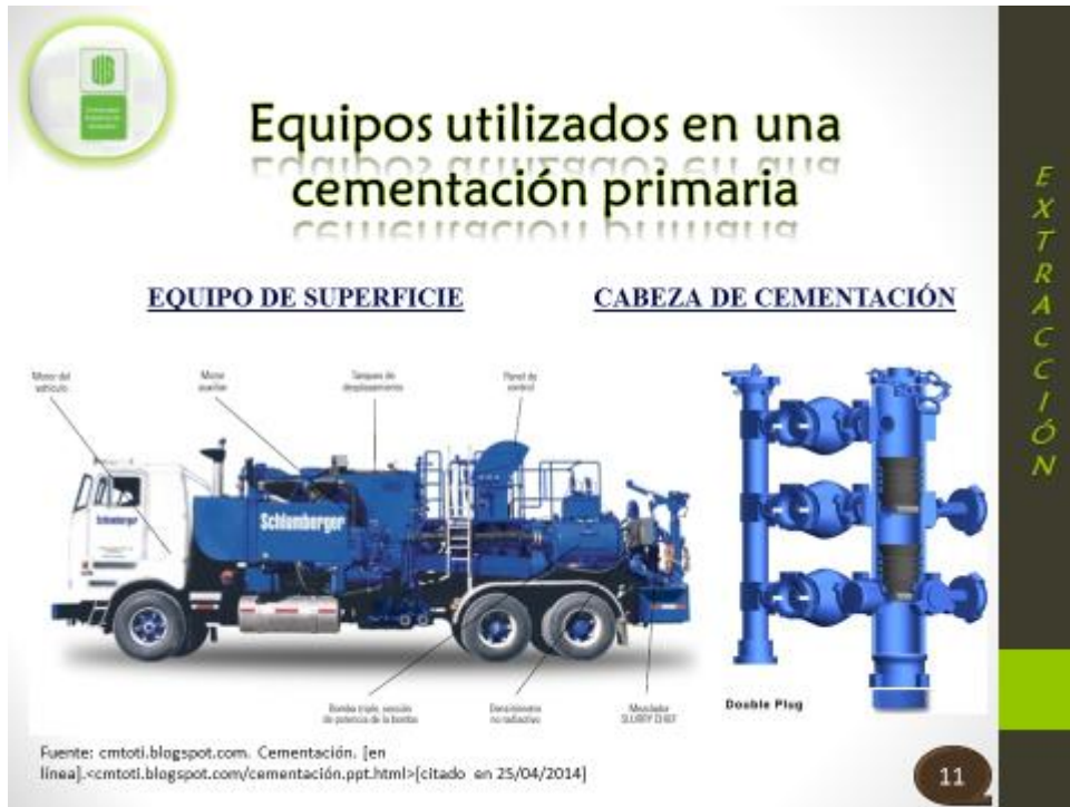
Figura 88 Equipos Utilizados en una Cementación Primaria
