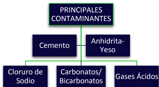
Figura 79 Principales Contaminantes de los Lodos
