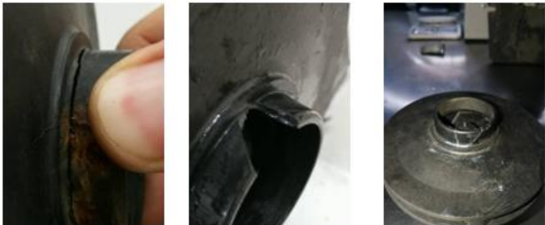
Figura 22 Daño del rodete antes y después
