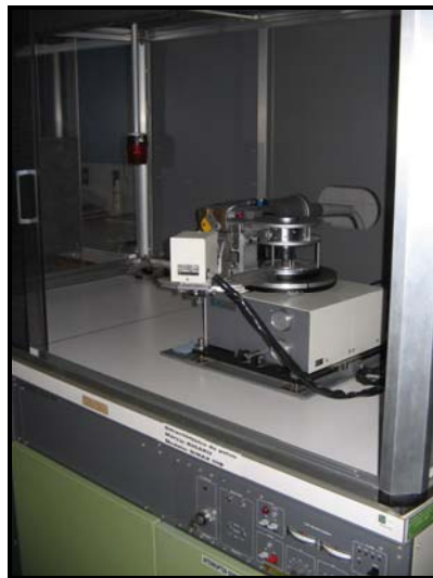
Figura 2. Aspecto del difractómetro de polvo marca RIGAKU modelo D/MAX IIIB, utilizada en los análisis de DRX. Escuela de Química, Universidad industrial de Santander.
