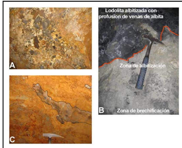
Figura 16. A. Aspecto de una zona de brechificación (fotografía a escala de afloramiento de la muestra COR 030 020). B. aspecto de una zona albitizada (en coloración blanca en la fotografía y zona de brechificación abajo (muestras COR 030 014 y 015), en contacto con lodolita carbonosa con profusión de venillas de albita, arriba). C. Desarrollo de zonas de bandas y bolsas albitización + pirita (delineado en negro), en contacto con una zona que presenta alta oxidación (muestra COR 030 019).
