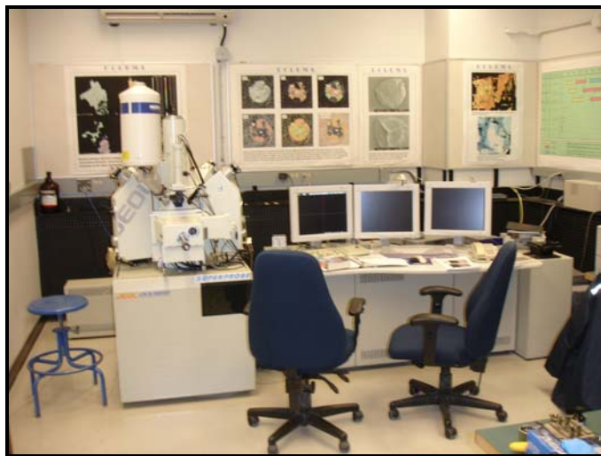
Figura 4. Aspecto de la Microsonda electrónica, utilizada en el presente estudio para análisis de química mineral. Microsonda JEOL modelo JXA-8200.
