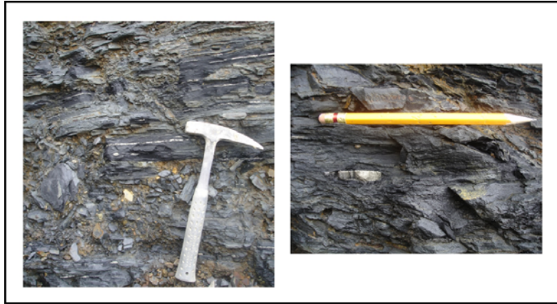
Figura 20. Nódulos o lentes de pirita en lodolita negra carbonosa, paralelos a la Laminación.
