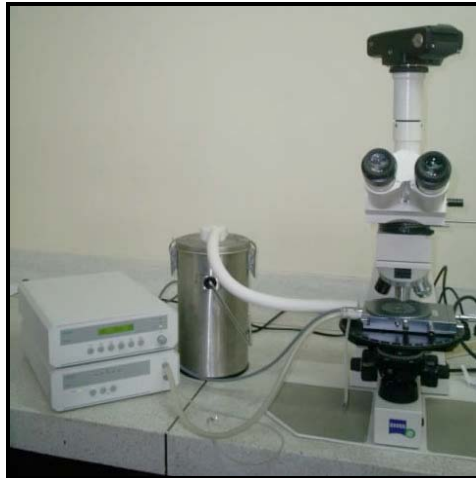
Figura 3. Aspecto de la Platina TH600 marca LINKAM, utilizada en el estudio de microtermometría de inclusiones fluidas. Escuela de Geología, Sede Guatiguará, Universidad Industrial de Santander (UIS).
