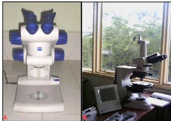
Figura 1. A. Aspecto de la lupa Estereoscópica Stemi DV4, Carl Zeiss Jena, utilizada en la descripción macroscópica de las muestras de mano recolectadas. B. Aspecto del microscopio de Luz Transmitida Nikon Elipse 50i, utilizado en el estudio mineralógico-petrográfico y petrografía de Inclusiones Fluidas.
