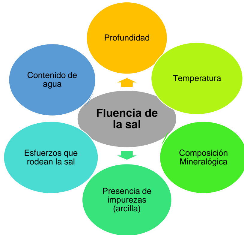
Ilustración 22. Factores que afectan la fluencia de la sal.
