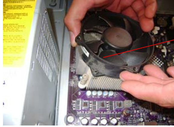
Retiro el ventilador
