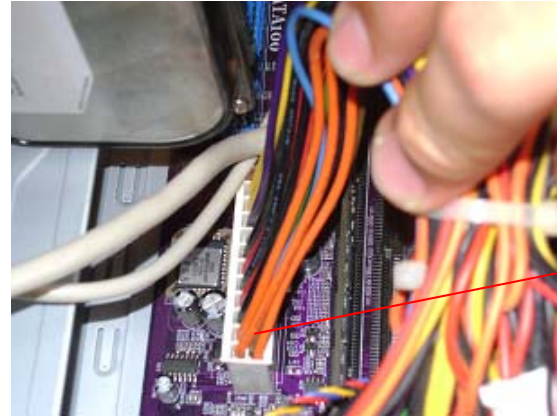
Retirar cables de alimentación de la board venidos desde la fuente
