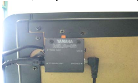
Figura 42. Caja de Conexión al Micrófono, Audífono y a la Unidad Principal Fuente: El Autor.
