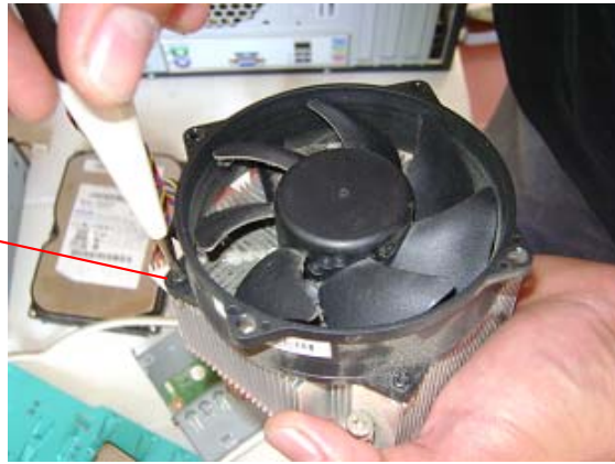
Retiro ventilador del disipador.
