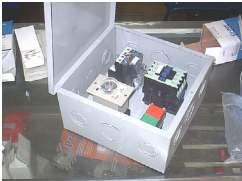
Figura 56 Caja de Paso con los elementos de control.
