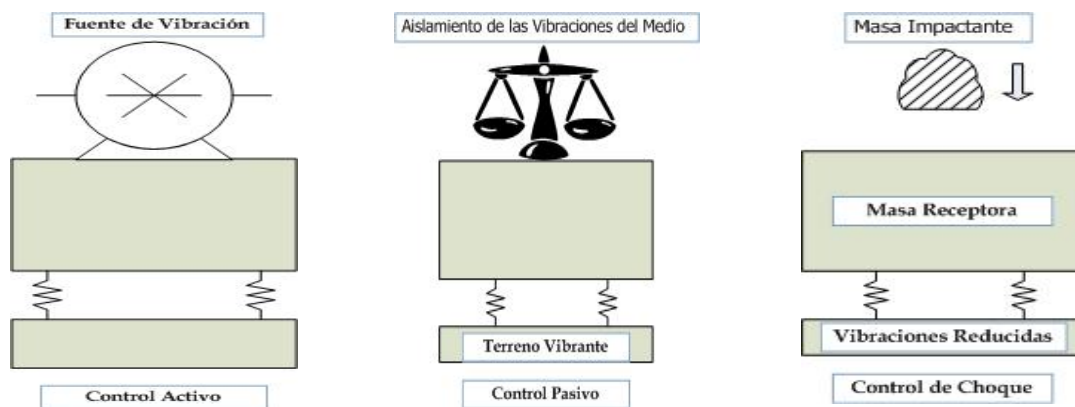
Figura 12 Controles De Vibración.
