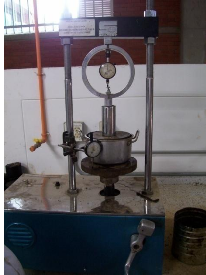
Figura 3.8. Maquina Marshall para determinación de modulo elástico.
