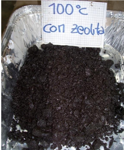
Figura 3.3. Mezclas asfáltica tibia (100°C) con zeolita
