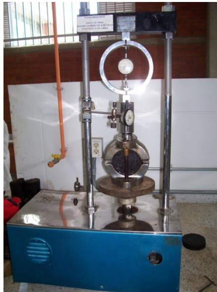
Figura 3.9. Maquina Marshall para determinación de la estabilidad y flujo.
