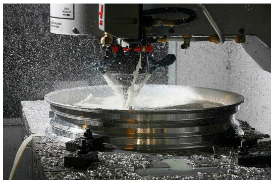
Figura 1. Acabados finales de un rin
