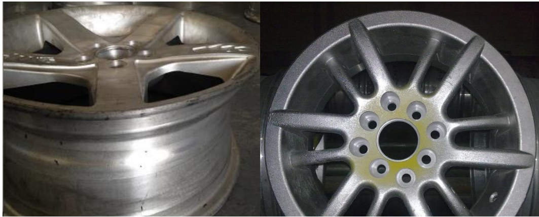
Figura 10. Rines ensayados bajo la NORMA 4177
