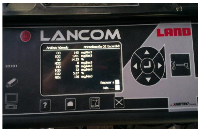
Figura 20. Captura de información a través del analizador de gases LANCOM
