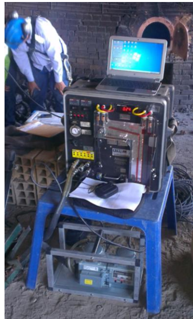
Figura 16. Encendido y calibración del equipo del muestreo Isocinético
