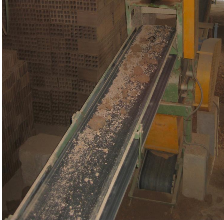
Figura 9. Banda transportadora de la empresa Ladrillos y Acabados S.A.S.
