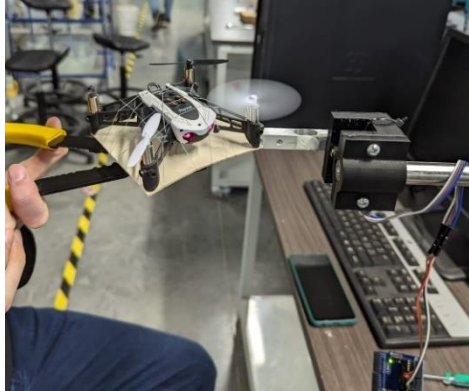
Figura 42. Montaje de medición de torque
