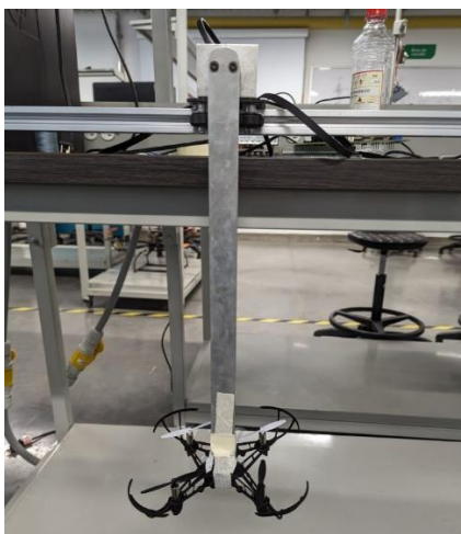
Figura 32. Montaje del sistema péndulo barra dron para el eje x.
