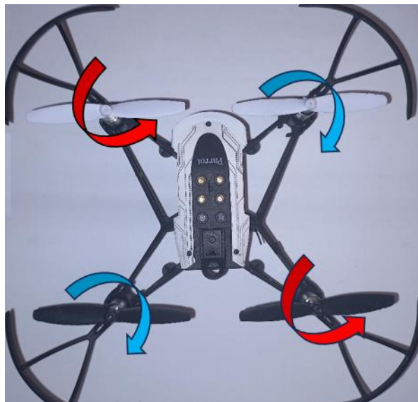
Figura 66. Sentido de giro de los motores
