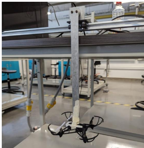
Figura 33. Montaje del sistema péndulo barra dron para el eje y.
