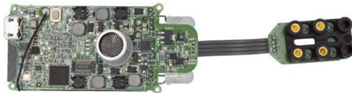
Figura 18. Parrot Mambo SIP6 Linux Motherboard con 800MHz ARM A9.
