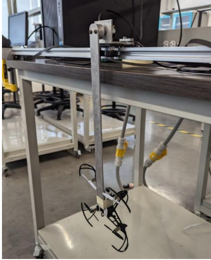
Figura 34. Montaje del sistema péndulo barra dron para el eje z.
