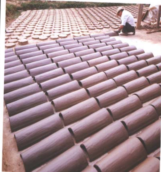
Fotografía 11. Proceso de fabricación de teja
