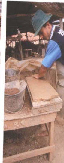
Fotografía 11. Proceso de fabricación de teja
