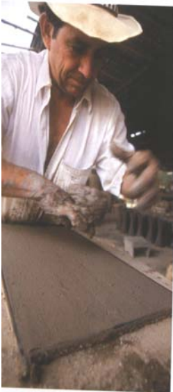
Fotografía 11. Proceso de fabricación de teja
