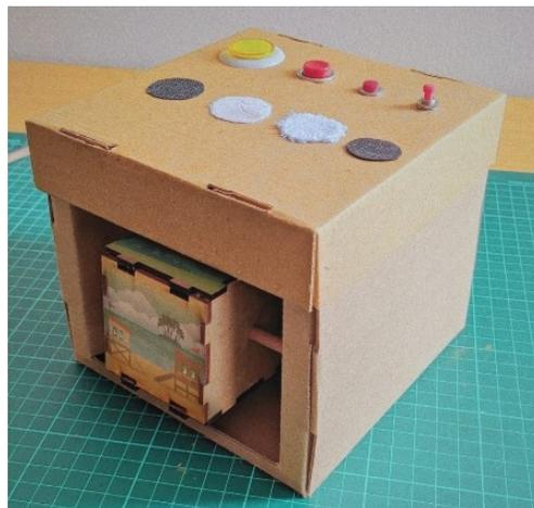
Teniendo en cuenta los resultados de las evaluaciones anteriores, se elaboró un prototipo de verificación a partir de una estructura cúbica, con el fin de comprobar la pertinencia del uso de recursos como pulsadores, texturas y el sistema de elección de escenas por medio de cubos sobre un eje planteados en la alternativa número dos. Este prototipo se presentó a diez niños en el
