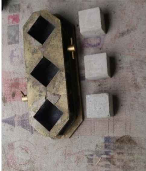
Figura 26. Toma de muestras de mortero.
