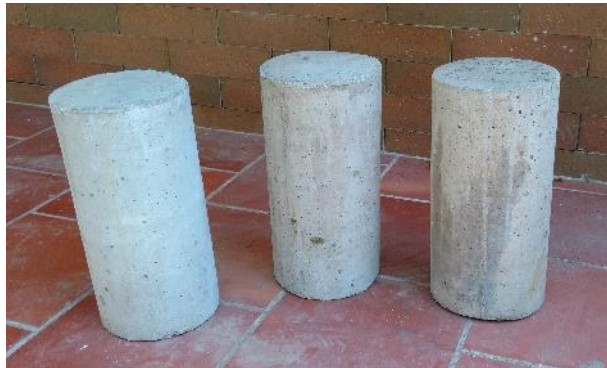
Figura 27. Toma de muestras de hormigón.
