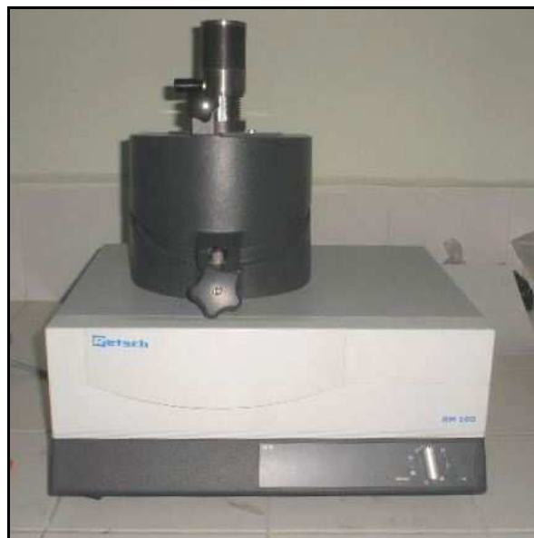
FIGURA 4. Molino Mecánico con Mortero –RM100, marca Retsch, empleado en el proceso de trituración de muestras para la difracción de rayos X.
