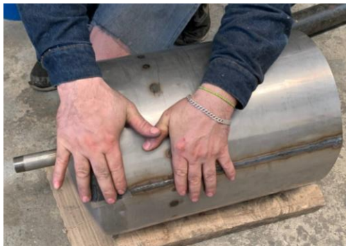
Figura 41. Soldadura cuerpo interno y cabezal macerador
