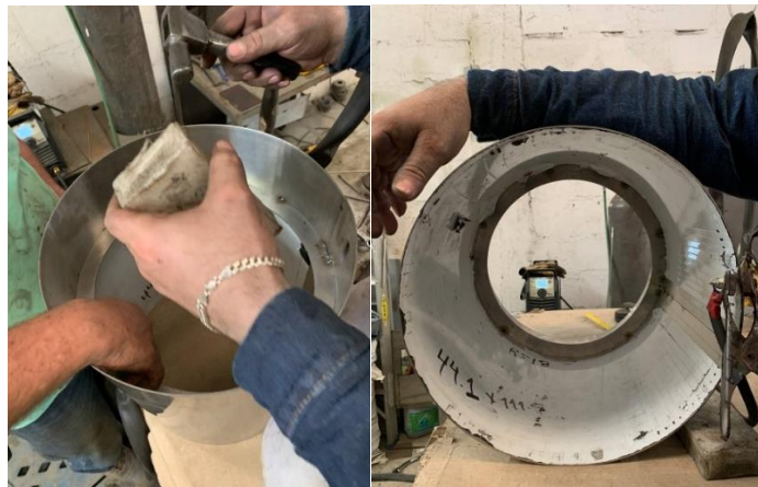
Figura 39. Soldadura envoltorio y soporte criba
