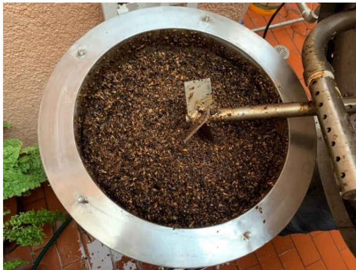
Figura 61. Mezcla malta-agua en el macerador
