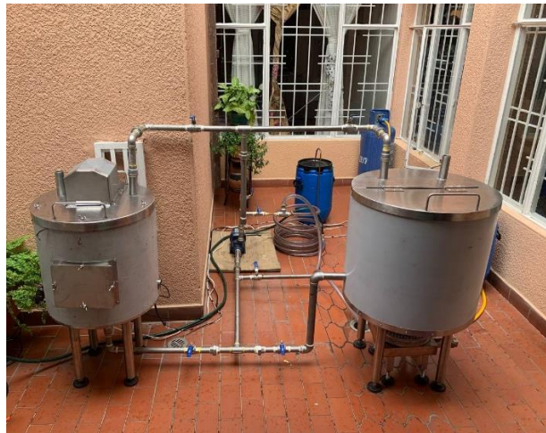
Figura 58. Ensamble del módulo de maceración-cocción
