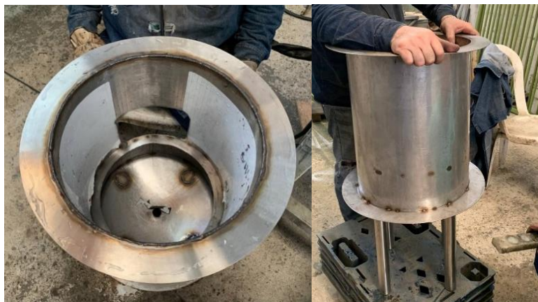
Figura 43. Soldadura arandelas macerador
