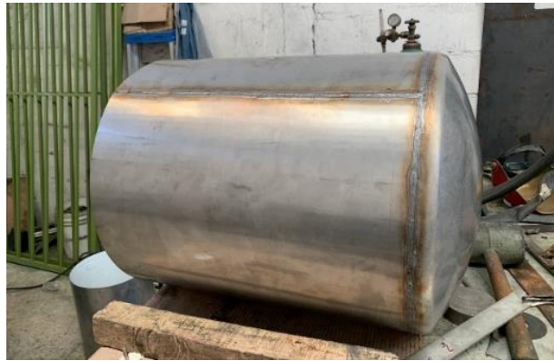
Figura 31. Soldadura cuerpo interno y cabezal hervidor
