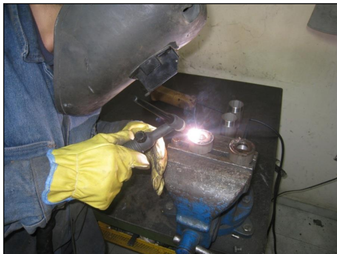
Figura 77. Proceso de soldado de la tuerca de empaquetadura.
