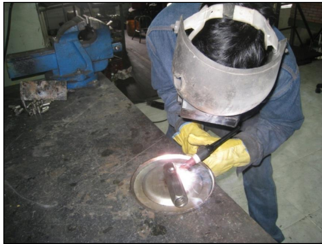
Figura 76. Proceso de soldado de los platos de sellado.
