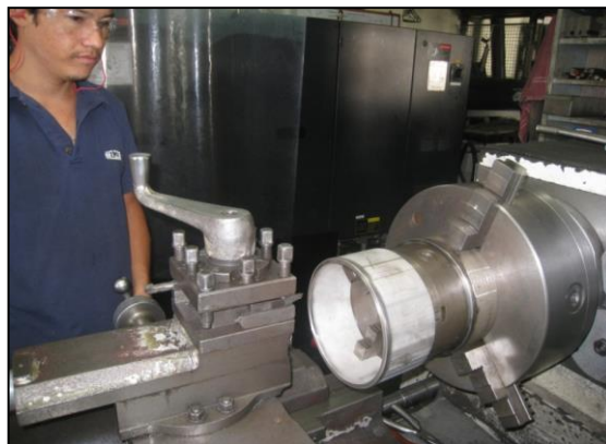
Figura 58. Maquinado de los acoples en el torno.
