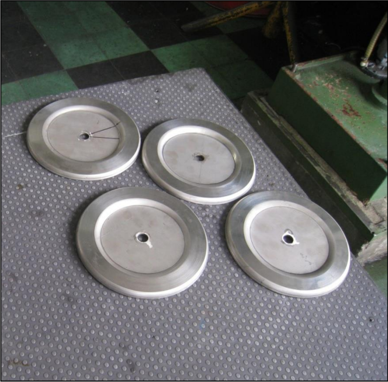
Figura 55. Platos de sellado después de haber sido estampados.
