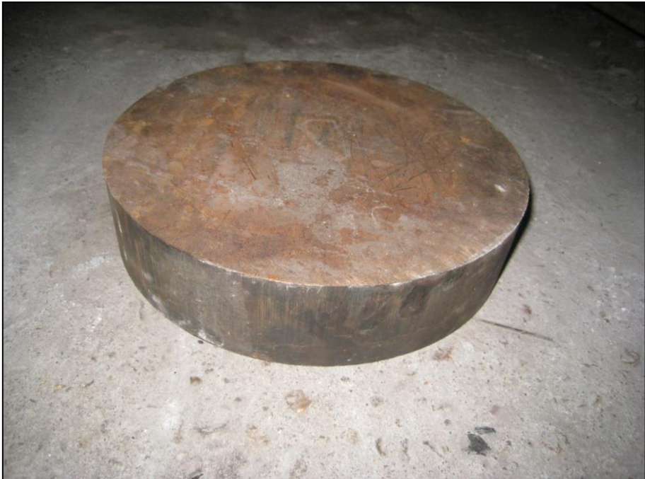
Figura 63. Material para la construcción de las matrices.
