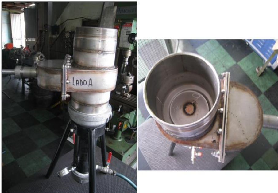
Figura 83. Prueba de hermeticidad del sello A.
