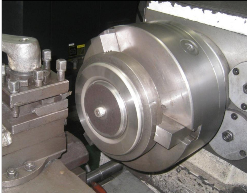
Figura 51. Utilaje de sujeción para los platos de sellado montado en el torno.
