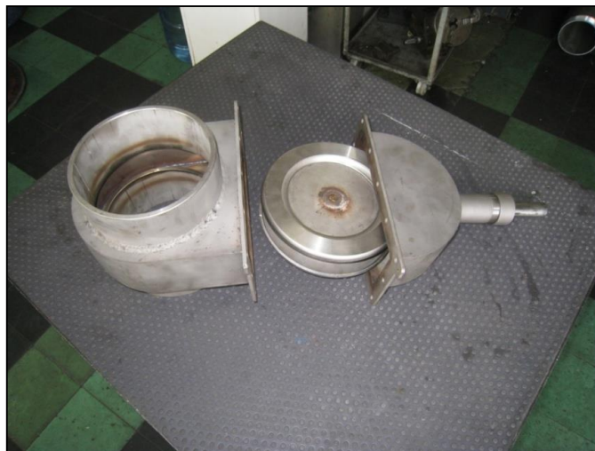
Figura 81. Ensamble de platos de sellado y tornillo roscado.
