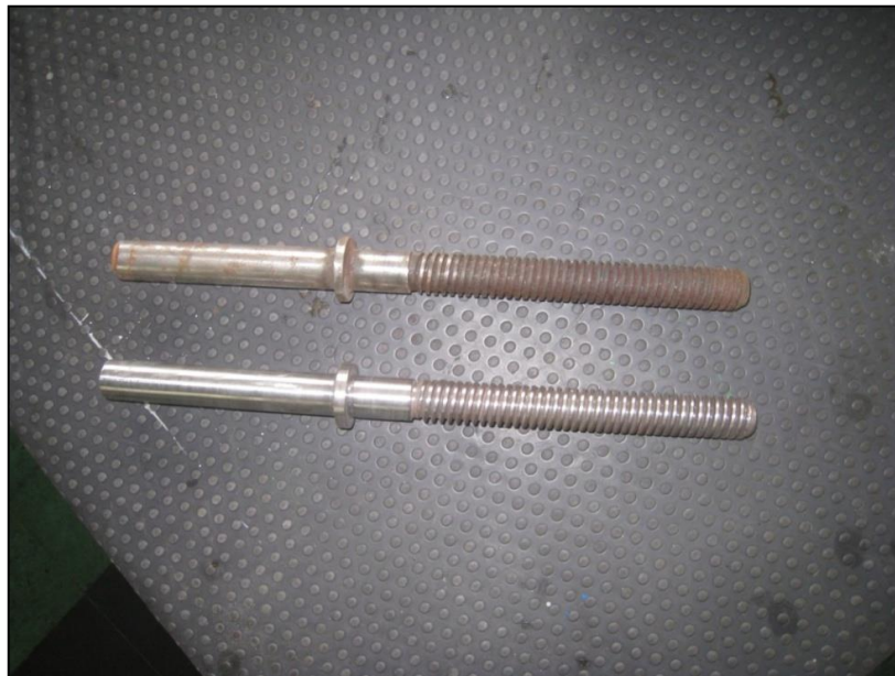
Figura 71. Tornillos con tratamiento térmico.
