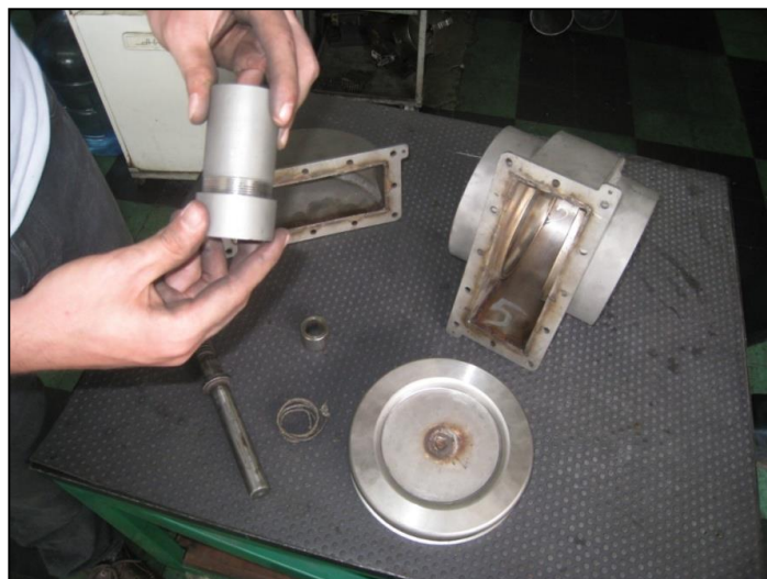
Figura 79. Ensamble de la tuerca de empaquetadura y buje de contención.
