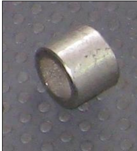
Figura 62. Anillo de compresión.
