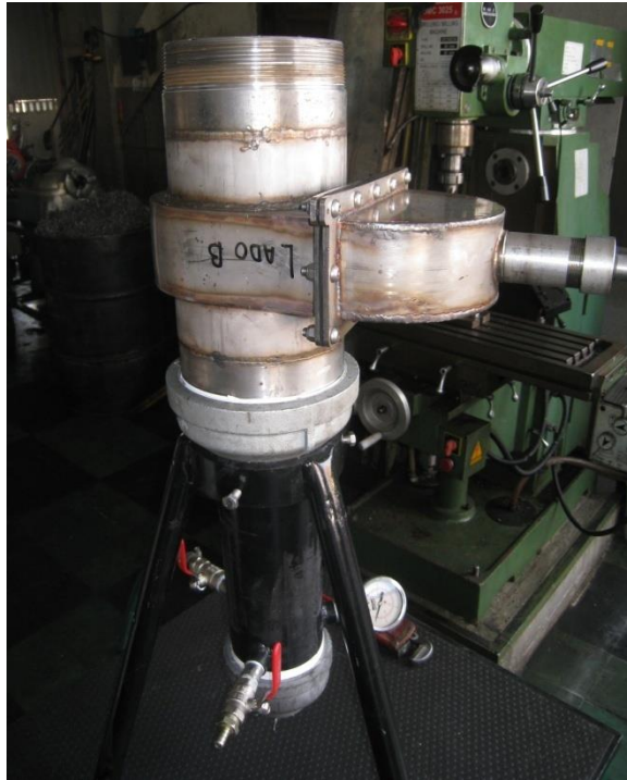
Figura 84. Prueba de hermeticidad del sello B.
