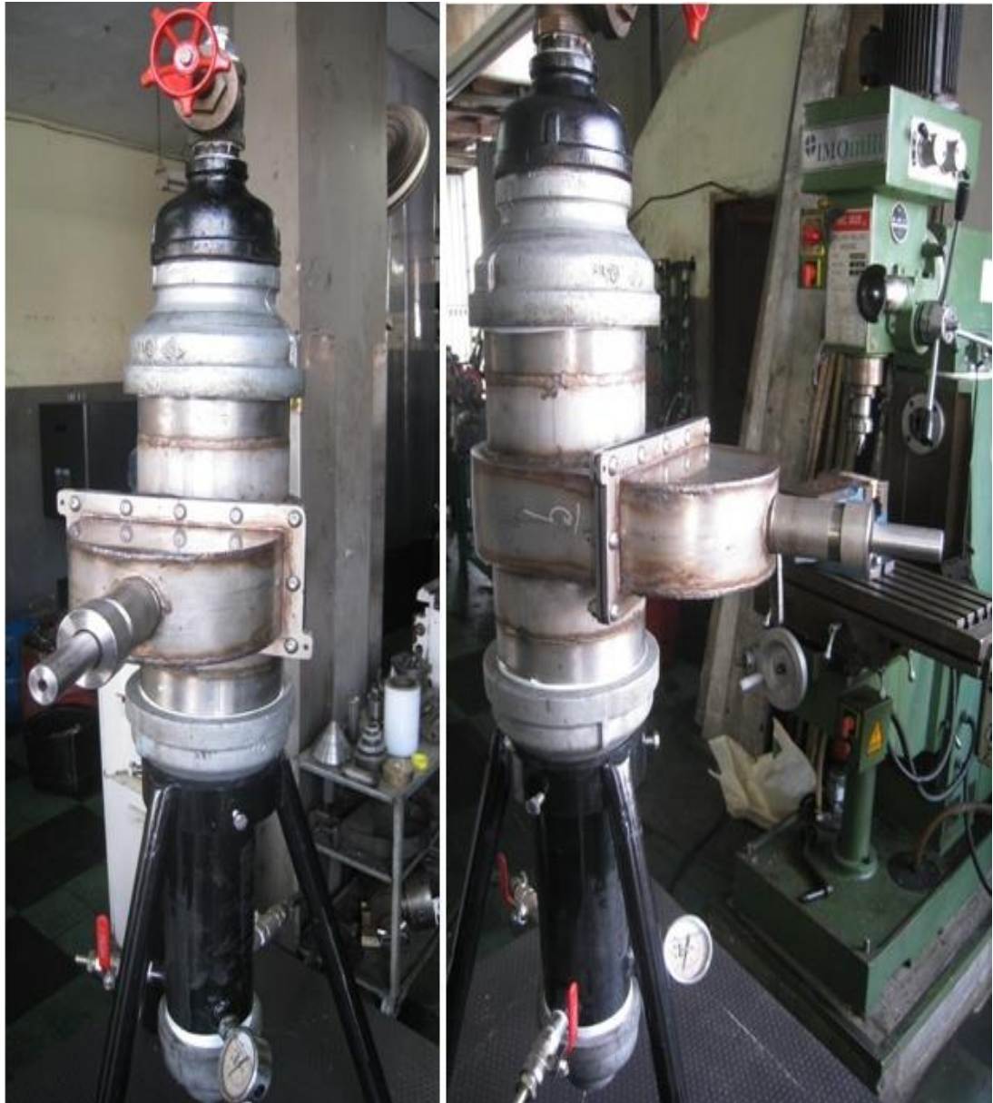
Figura 85. Prueba de hermeticidad del casco.
