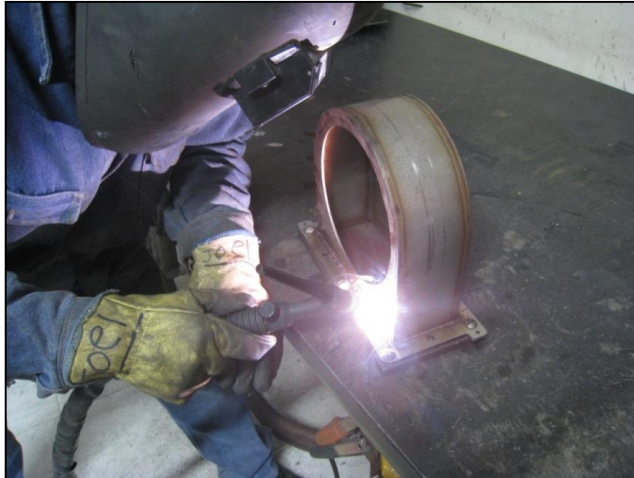
Figura 74. Proceso de soldado de la parte inferior del bastidor.
