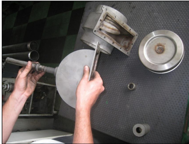
Figura 80. Ensamble del tornillo roscado y la parte superior del bastidor.
