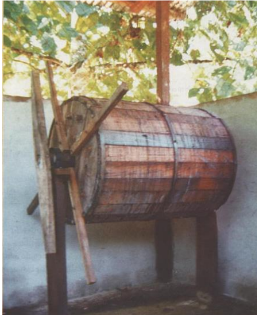
Figura 16. Fermentación en tambor rotatorio. Fuente: Fermente bien su cacao . Espinosa E., Perea A., Villamizar C., Calle L. 1998
