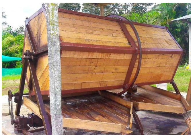
Figura18. Fermentación en tambor rotatorio hexagonal. Disponible en: https://nscoral.pe/cajon-fermentador-de-cacao/
