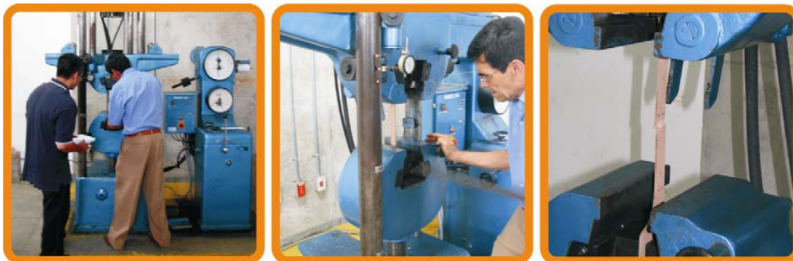
Figura 27. Recolección de datos prueba tensión.
