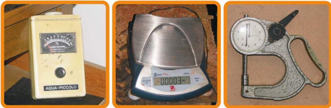
Figura 34. Elementos de medición prueba de higroscopicidad
