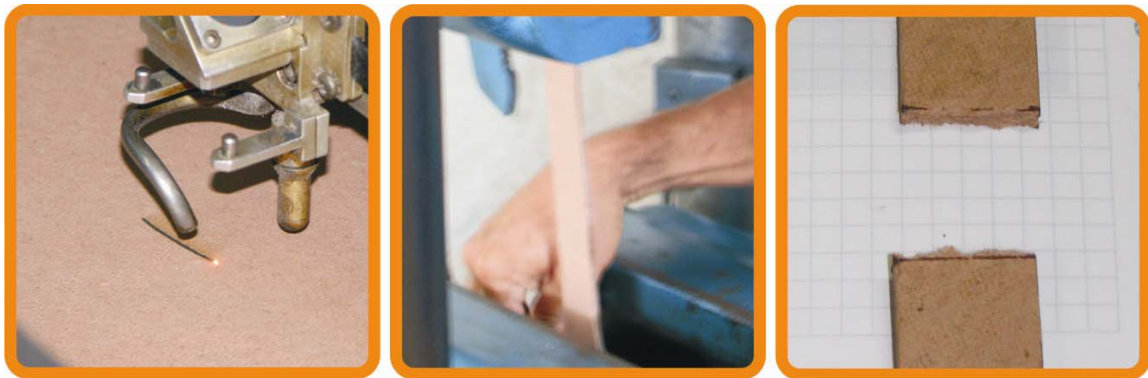
Figura 26. Corte, montaje y ruptura de una probeta en prueba de tensión.
