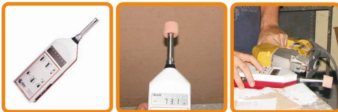
Figura 32. Sonómetro utilizado en la prueba de acústica.
