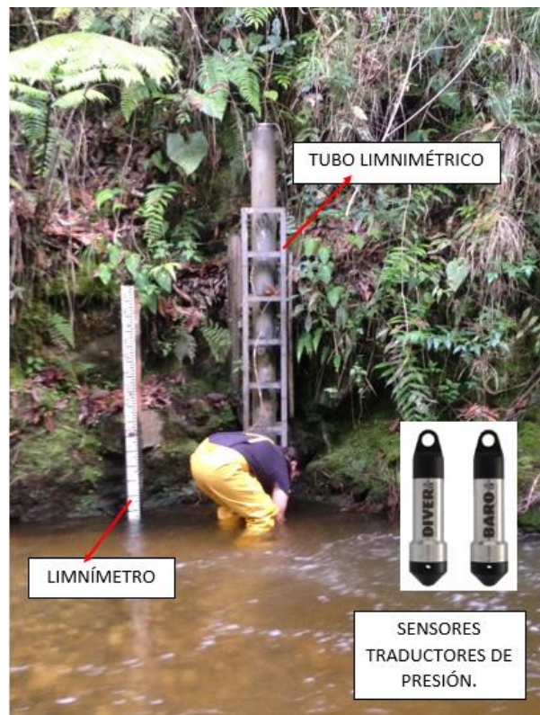
Figura 3. Estación automática de niveles y mira del Rasgón
