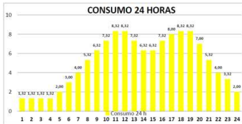
Figura 29. Consumo diario kWh Bodega producto terminado. Tomado registro med.EPM
