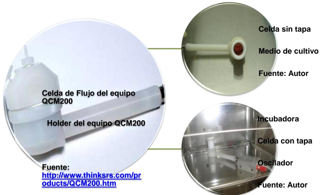
**Figura 6. Celda para pruebas microgravimétricas**
