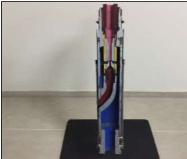
Figura 25: Instalación boquilla y garganta en inversa.
