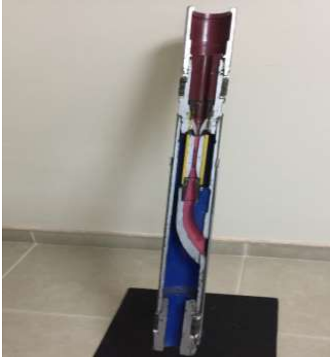
Figura 24: Instalación boquilla y garganta en directa.
