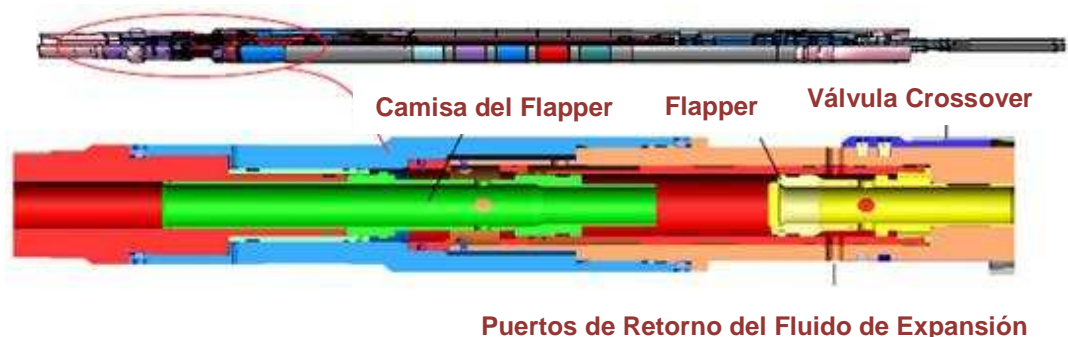
Figura 17. Herramienta de Asentamiento de un Colgador de Liner de Segunda Generación.
