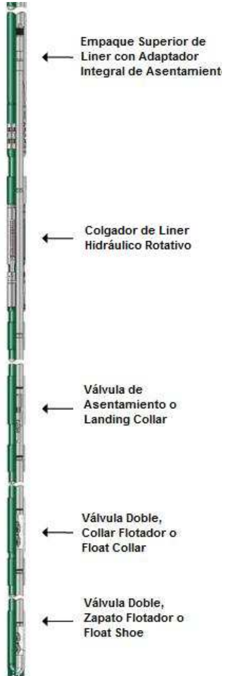
Figura 8. Herramienta Ensamblada Colgador Hidráulico de Alta Resistencia, Deslizable y Rotativo con Empaque en la Parte Superior del Liner.
