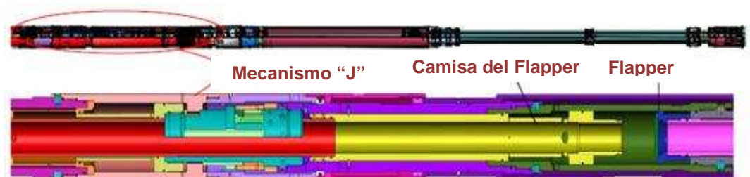
Figura 20. Asentamiento Secundario del Flapper.
