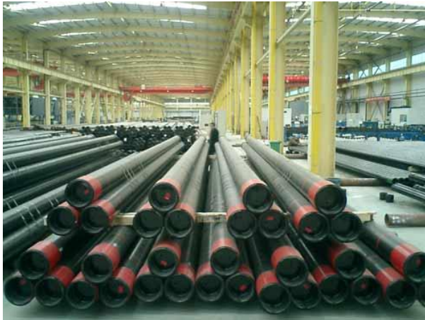
Figura 1. Tubería de revestimiento (Casing)
