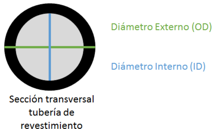
Figura 3. Diámetro externo e interno de revestimiento.
