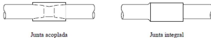
Figura 6. Junta acoplada vs Junta integral
