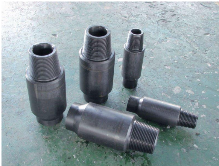
Figura 5. Conexiones o juntas
