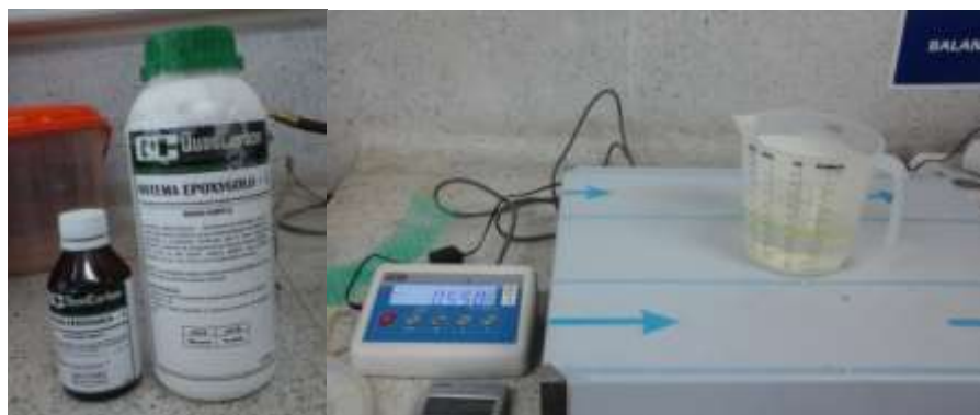
Figura 24. Mezcla de resina-endurecedor.
