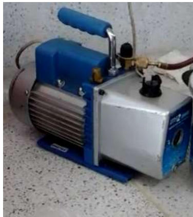
Figura 23. Bomba de vacío.
