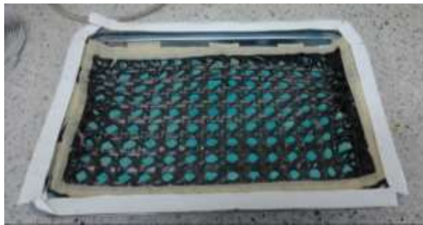
Figura 16. Ubicación del tejido de carbono en el molde.
