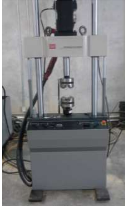
Figura 30. Máquina de ensayos MTS 810 (Material Testing Systems).
