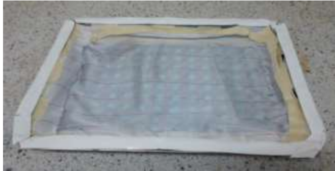
Figura 17. Ubicación del peel-ply (tejido antiadherente).
