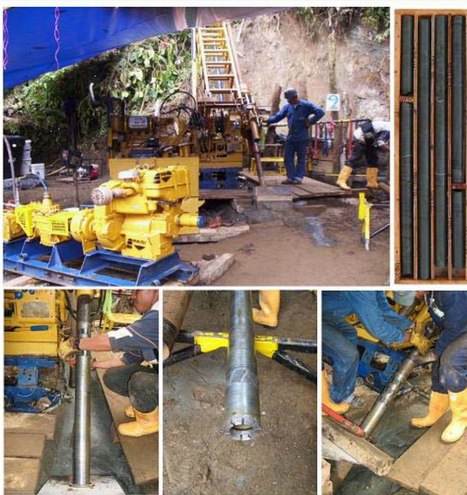
Fig 29. Montaje de maquinaria de perforación, inclinación de la perforación y resultado de testigos.
