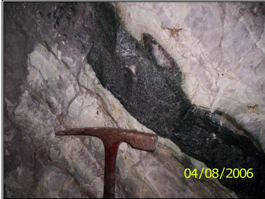
Fig 5. Melanodiorita de grano medio ligeramente silicificada. Obsérvese el Contacto inferior onduloso y neto con el Skarn. El contacto superior con formación de nódulo y de cristalización de granate con el Skarn. Localidad: Cruzada Oscar Darío Arango FR-314
