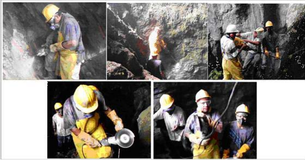
Fig 19. Empleo de cierra manual para la elaboración de los canales de muestreo y martillo PIONJER 120. Con su correspondientes elementos de seguridad industrial.
