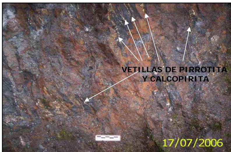
Fig 14. Mineralización masiva de Calcopirita y Pirrotina. Parte superior de la foto se aprecia bandeamiento composicional en la roca protolito. Roca Silisificada. Zona de Skarn. Localidad: Afloramiento El Machongal. Superficie con minerales de oxidación.
