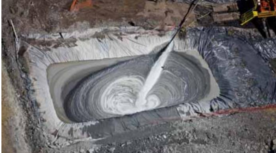
Figura 8. Balsa de evaporación y residuos de fluido de retorno.
