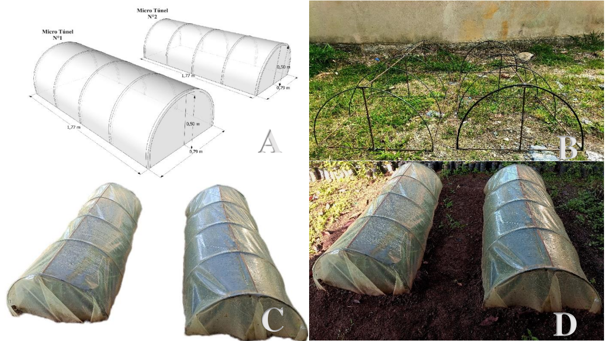
Figura 3. Diseño y construcción de los micro túneles.
