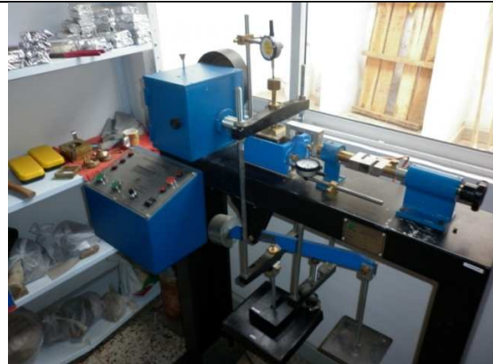
Ensayo de Corte Directo (CD)
