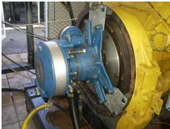
Figura 51. Montaje de Dinamómetro en el Motor KTA-38
