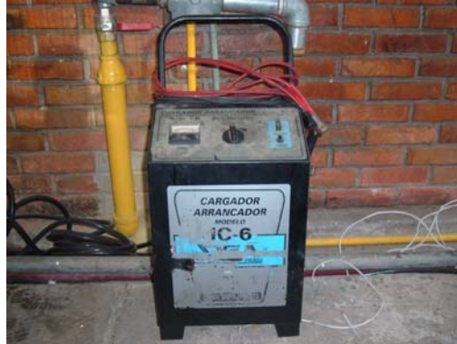
Figura 79. Cargador de Baterías.
