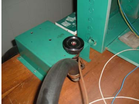
Figura 112. Válvula de Control de Carga.
