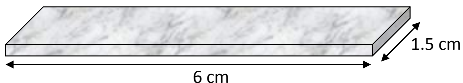
Figura 4. Boceto de dimensiones de la probeta de aluminio de alta pureza
