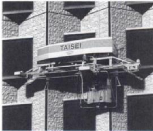
Figura 7. Robot de pintado “TPR-02”.
