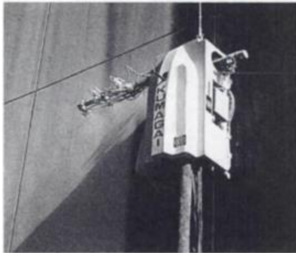
Figura 6. Robot de pintado "KFR-2".
