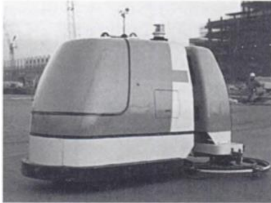
Figura 4. Robot finalizador de concreto de Obayashi.
