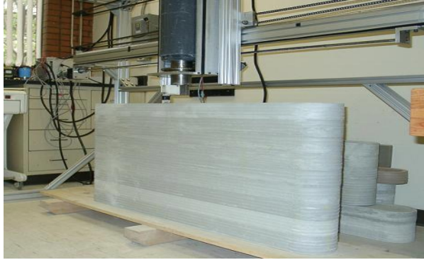
Figura 28. Formaleta de Concreto fabricada por la máquina de CC.
