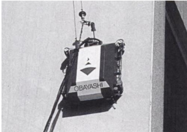
Figura 10. Robot de inspección de baldosas de Obayashi
