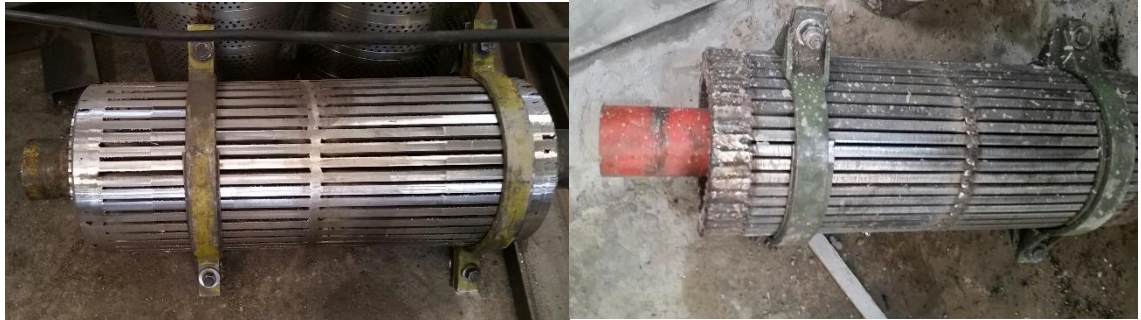
Figura 23. Canasta de acero XAR 400 sin mecanizar (a) y mecanizada (b).
