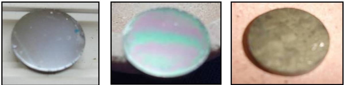
Figura 35. Fotografía de algunos recubrimientos Ni-P oxidados por 2h a 700° C. (a)NiP, (b) NiPM, y (c) NiPMBCe
