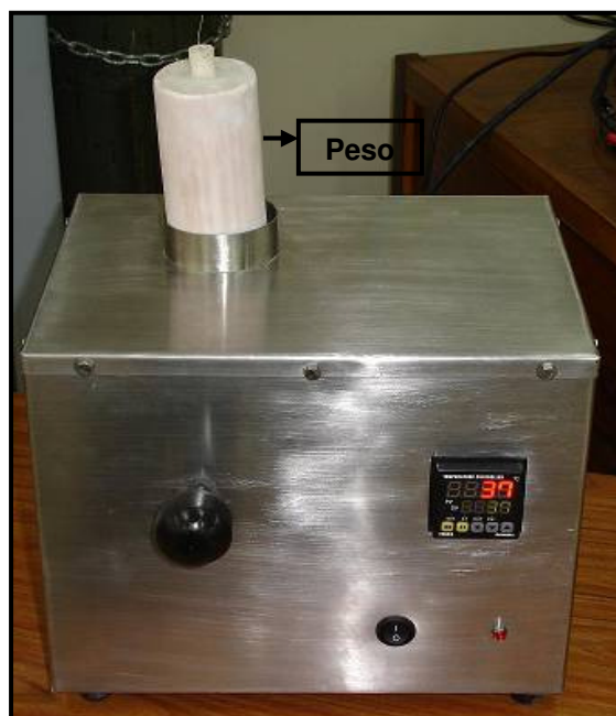
Figura 31. Fotografía del horno-celda para ensayos IS.
