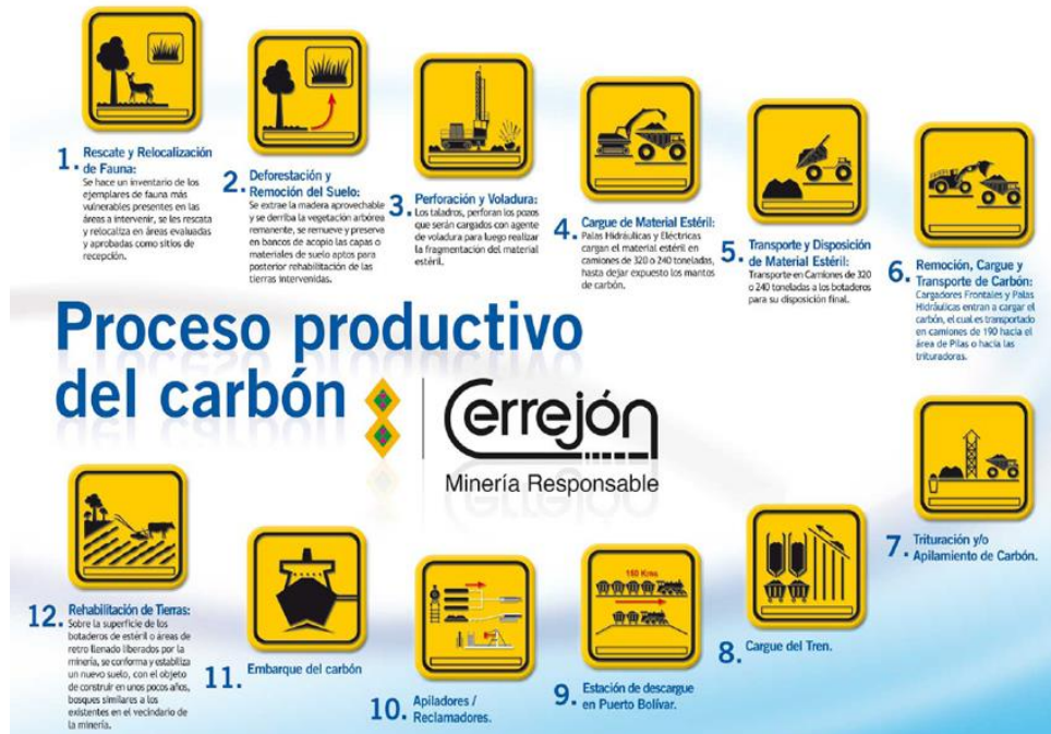
Figura 30. Proceso Productivo del Carbón.
