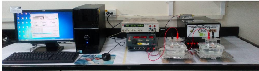
Figura 7. Montaje de anodizado
