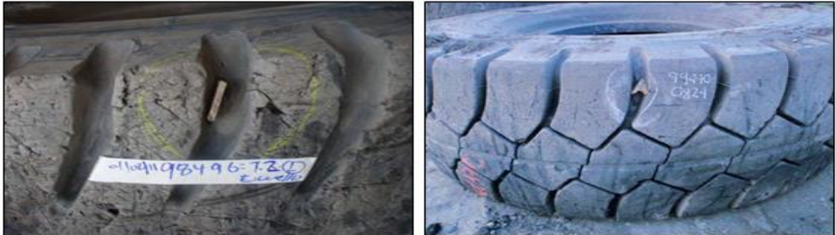
Figura 16. Daño por objeto metálico
