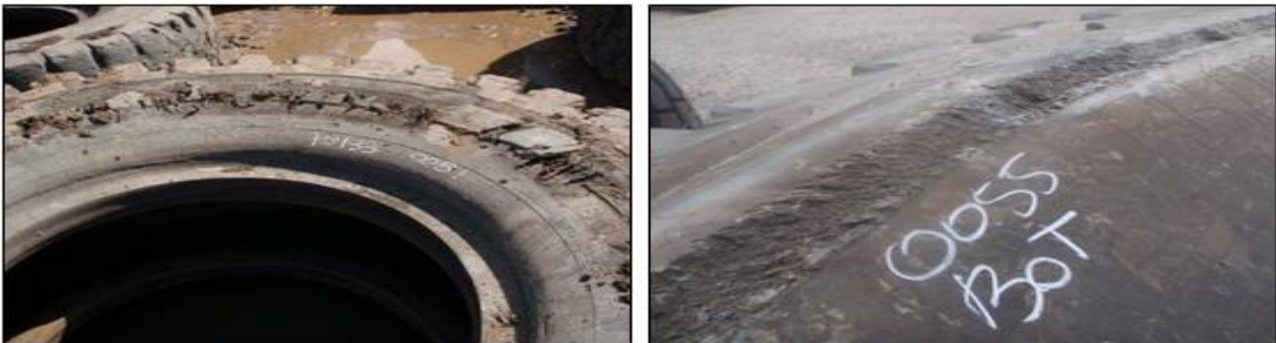
Figura 17. Roce en el costado
