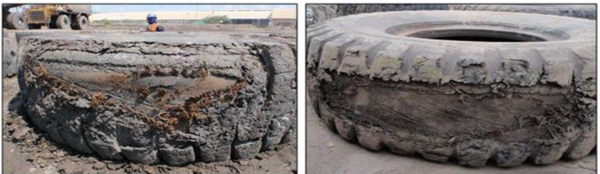
Figura 7. Desgarre de la banda de rodamiento por corte
