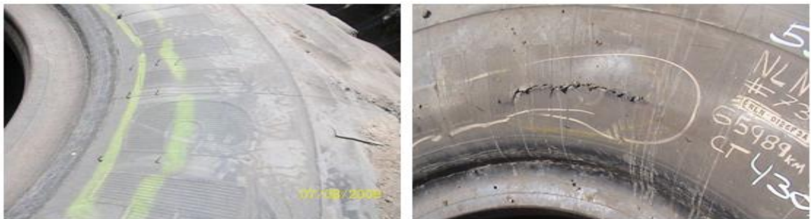
Figura 19. Rotura del retorno
