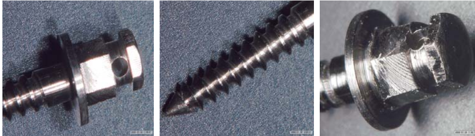
Fotografías de Minitornillo de Ti6Al4V en condiciones de entrega, 40X y 100X.
