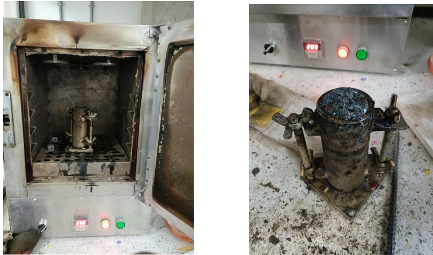
Figura 5. Mezclado y fabricación probetas cilíndricas.
