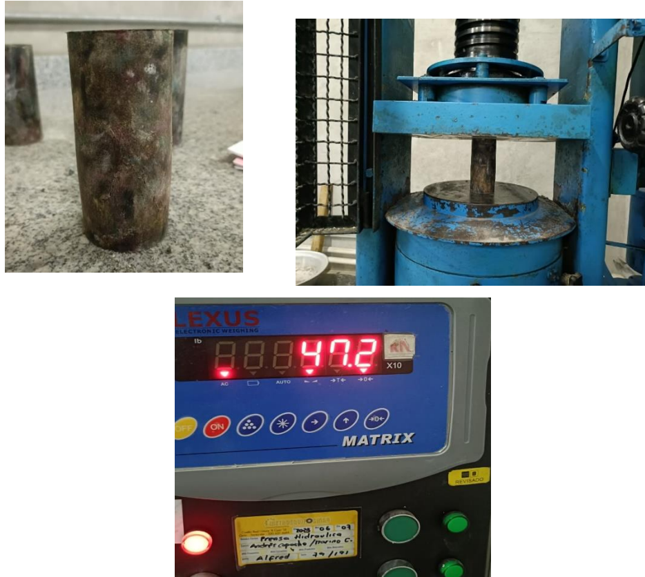
Figura 7. Resultados ensayos a compresión probetas cilíndricas.
