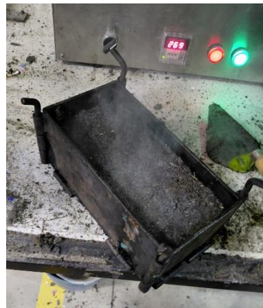
Figura 12. Distribución y mezclado fibras metálicas.
