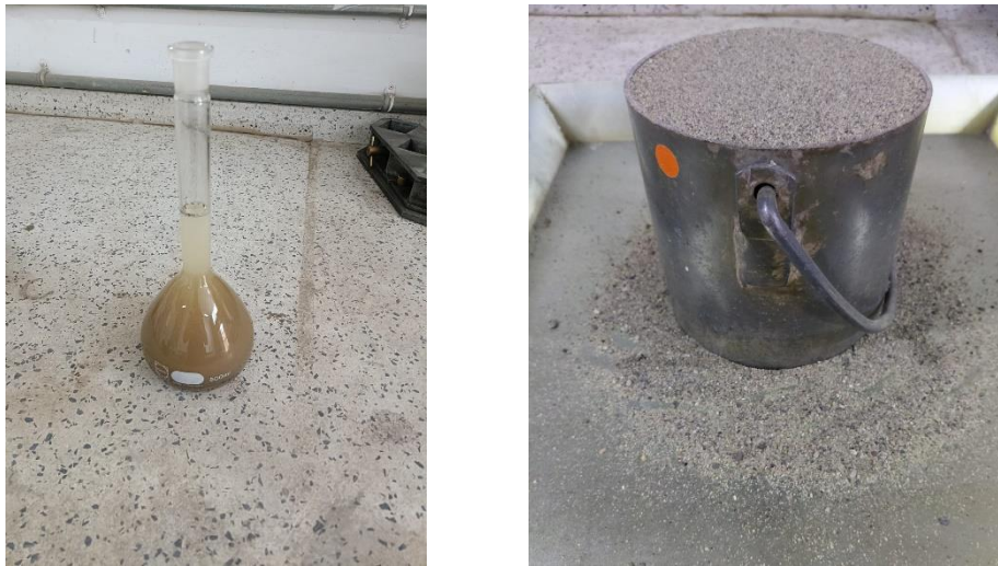
Figura 1. Muestra el ensayo de peso específico a través de un picometro y 300 gramos de arena, así mismo la realización del peso unitario de la arena en condición suelta.
