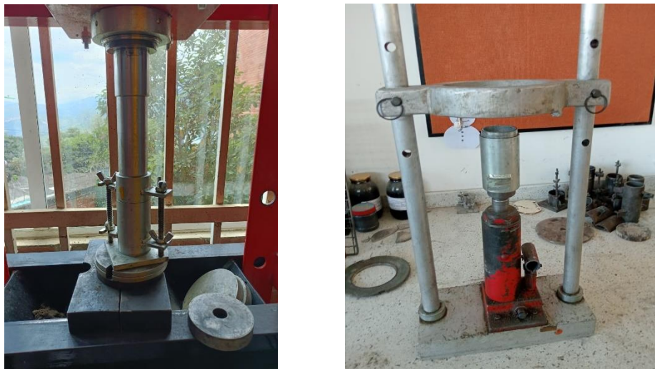
Figura 6. Compactación y desencofre de las probetas cilíndricas.
