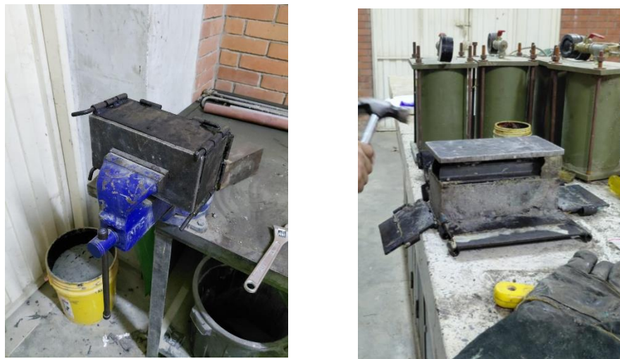
Figuras 10. Compactación y desencofre del adoquín.
