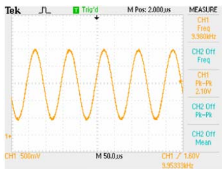
Señal de excitación de 2Vpp en 10kHz
