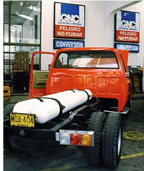
Sus longitudes y diámetros varían de acuerdo con su capacidad de almacenamiento, la que oscila entre 5 y 25 m<sup>3</sup> aproximadamente. Su peso varía acorde con la capacidad del cilindro, llegando a alcanzar los 110 Kg. Poseen una válvula de bronce colocada directamente sobre la boca del cilindro, permitiendo el libre paso de gas desde y hacia los cilindros, son de cierre manual.
