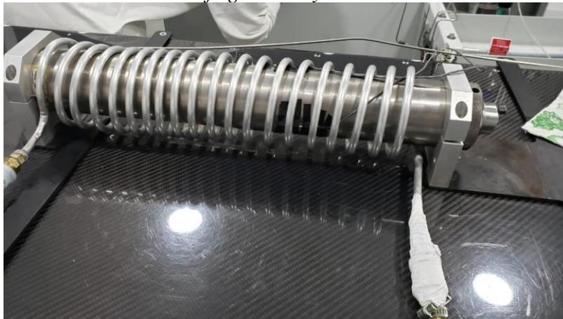
Al interior del *coreholder* en el espacio anular entre las paredes del recipiente y la manga de caucho se fluyó agua para generar una presión de confinamiento de 500 psi a la roca. Esto se hizo con el fin de que el agua contribuyera a un enfriamiento más rápido de la muestra. Una vez se alcanzó la temperatura deseada de  $9^\circ\text{C}$  en una de las termocuplas, se procedió a realizar un
